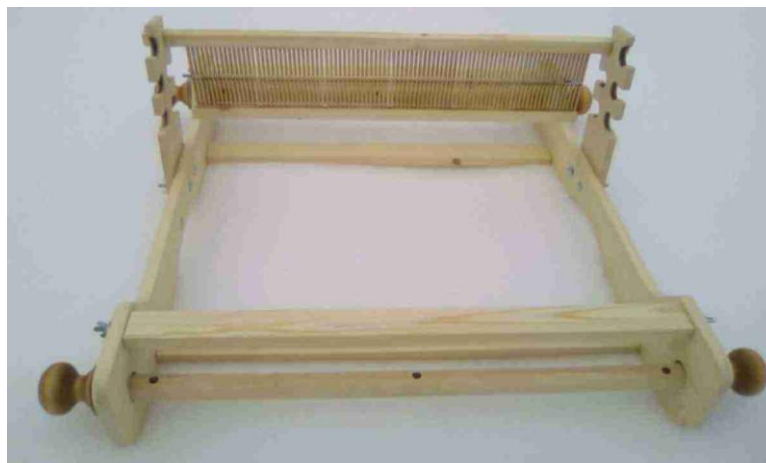
Рисунок Л.1 – Найпростіший рамний верстат
