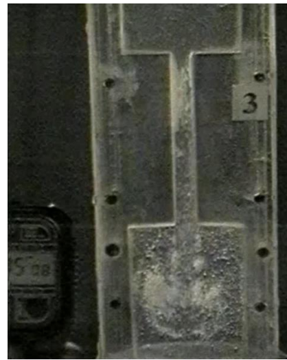
Рис. 8. Фотографія прозорого каналу з рідиною, що коливається в момент втягування рідини у камеру пульсації: виникнення кавітаційної каверни та кавітаційних пухирців при збільшення частоти коливань до 10 Гц
