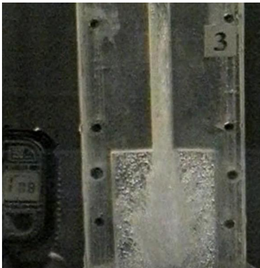
Рис. 9. Фотографія прозорого каналу з рідиною, що коливається в момент втягування рідини у камеру пульсації: виникнення кавітаційної каверни та кавітаційних пухирців при збільшення частоти коливань до 14 Гц
