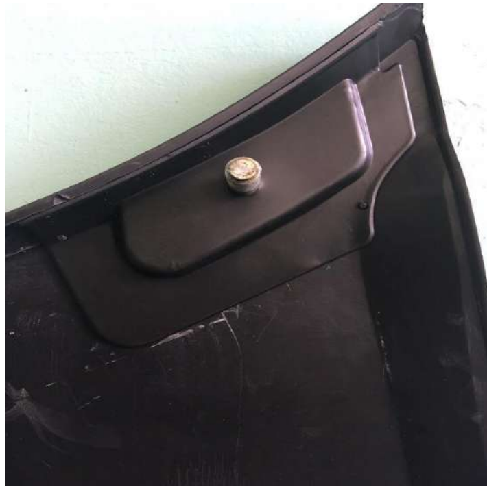
Рисунок 3.4 – Вставлення кріплення з болтом
