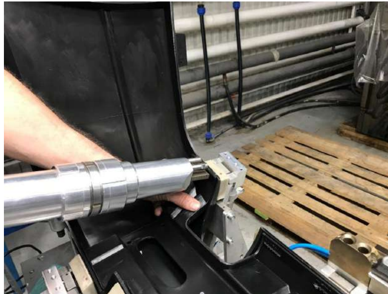
Рисунок 3.5 – Процес ультразвукового зварювання
