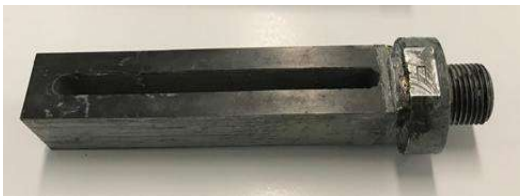
Рисунок 2.1 – Магніострикційний перетворювач із пермендюру.
