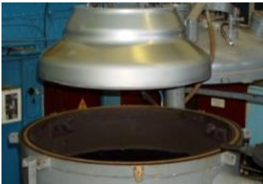
Рисунок 4.2 – Процес розгерметизації установки іонного азотування
