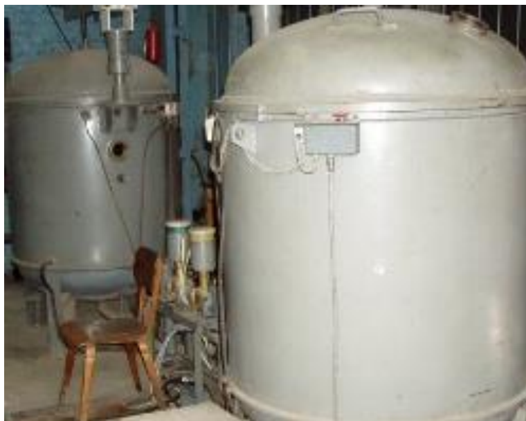
Рисунок 4.3 – Однокамерна установка іонного азотування «ПАС-2»
