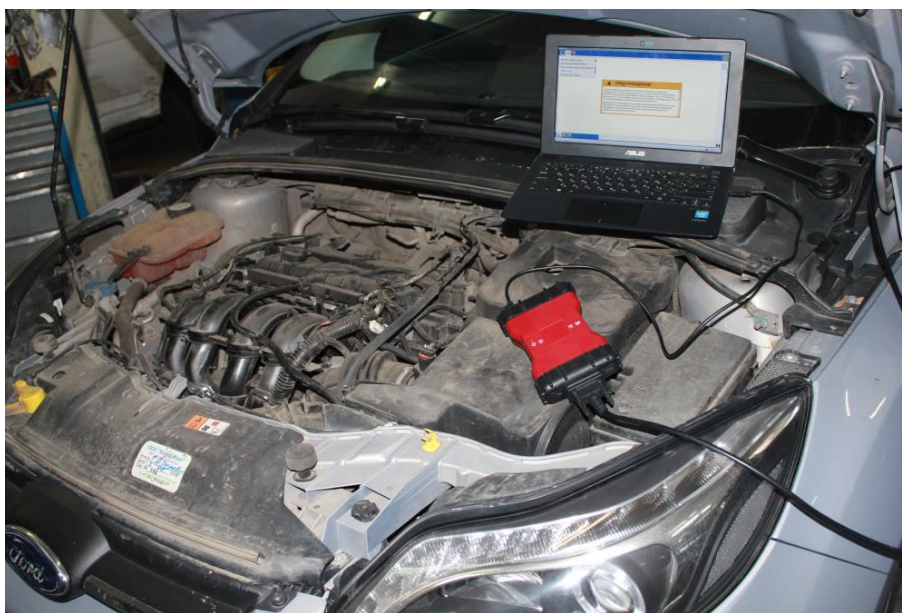
Рисунок 2.3 – Комп’ютерна діагностика АКПП автомобіля Ford Focus
