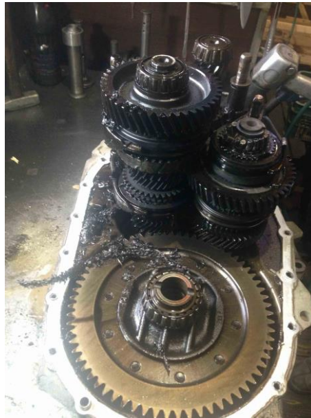
Рисунок 2.1 – Пошкодження в автоматичній коробці передач
