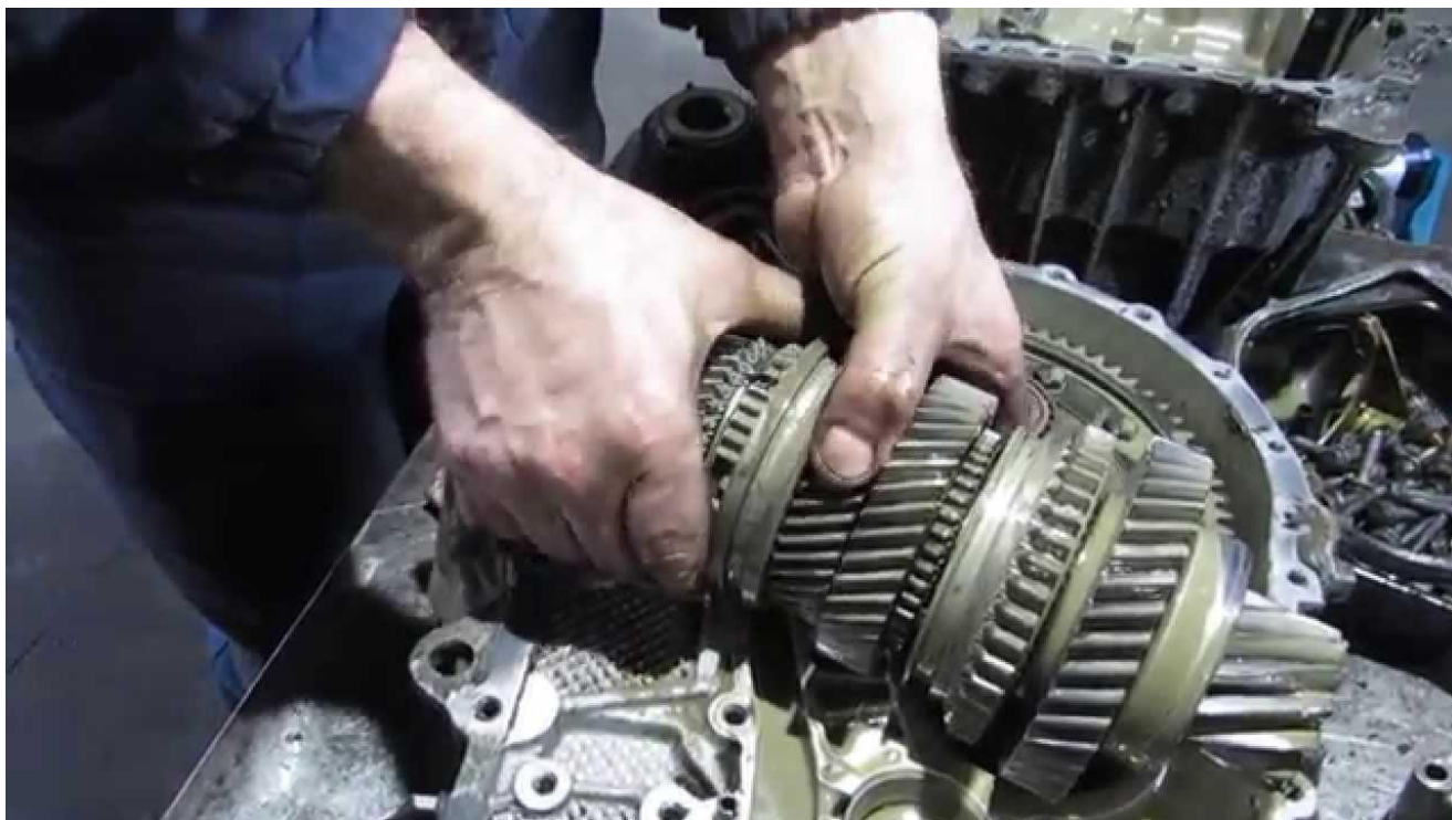
Рисунок 2.2 – Розборка АКПП автомобіля Ford Focus при проведенні ремонтних робіт
