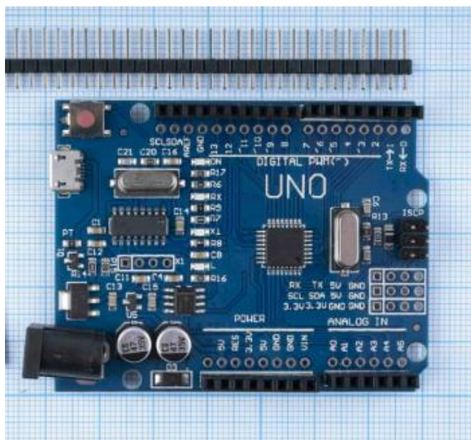
Рисунок 1.2 – Плата мікроконтролера Arduino UNO ATmega328 [52]
