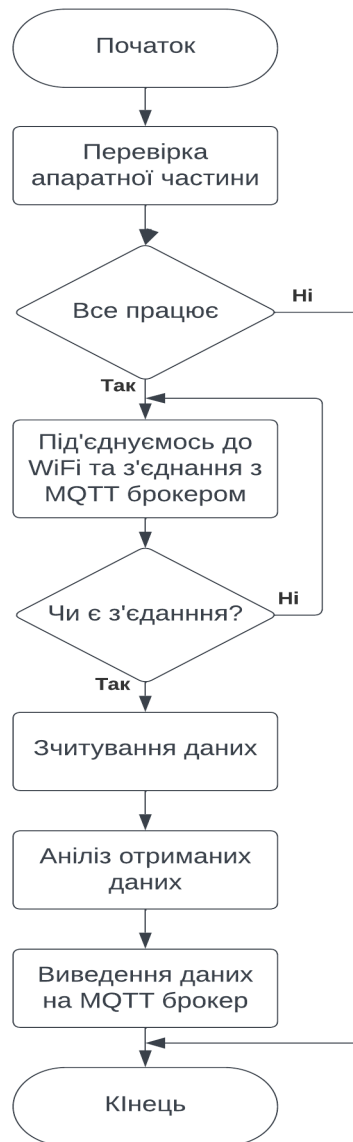
Рисунок 3.2 – Алгоритм роботи програмно-апаратного засобу для емулятора
