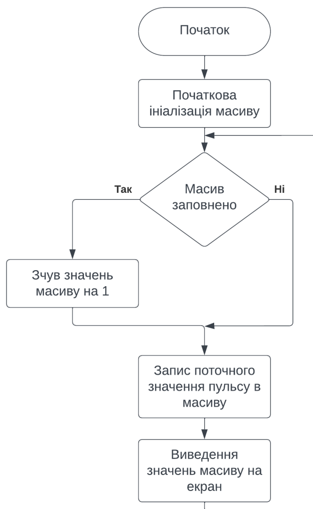
Рисунок 3.15 – Алгоритм роботи системи візуалізації даних
