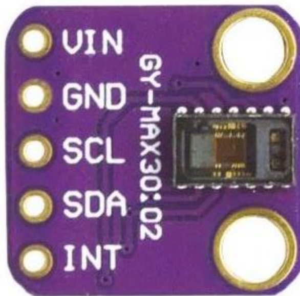
Рисунок 2.4 – Розташування пінів на MAX30102
