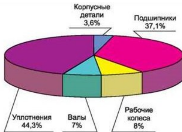
Рисунок 1.16 - Діаграма розподілу ушкоджень по елементах насосів
