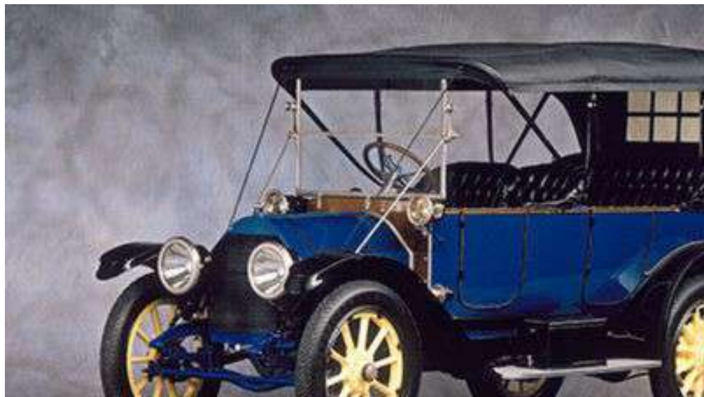
Рисунок 1.3 - Cadillac Model 30 – перший у світі автомобіль з електричним стартером та електричними фарами
