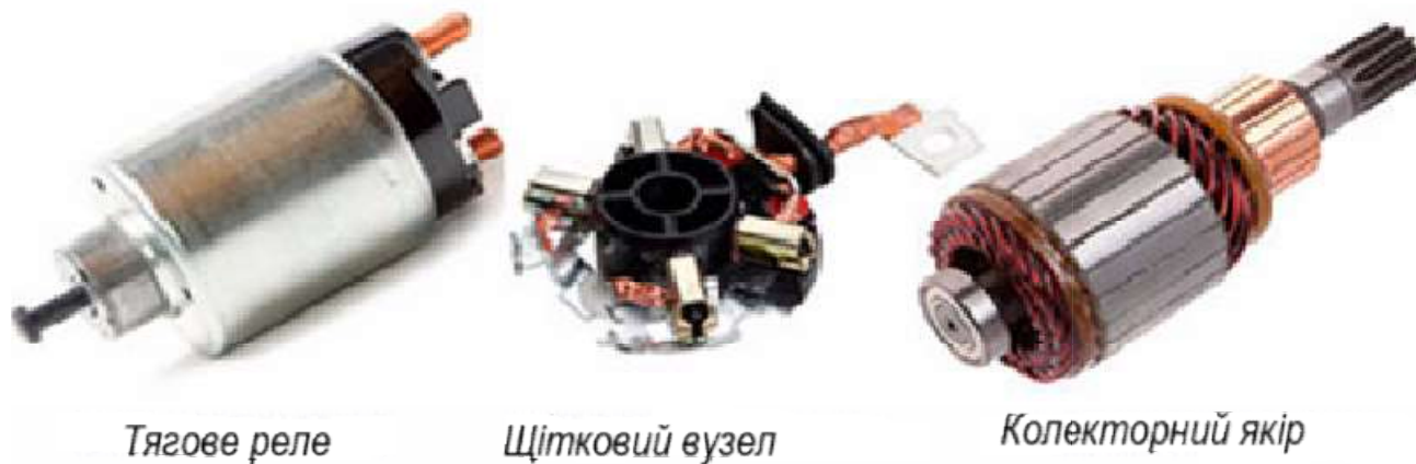
Рисунок 1.9 - Деталі стартера, які найчастіше виходять з ладу
