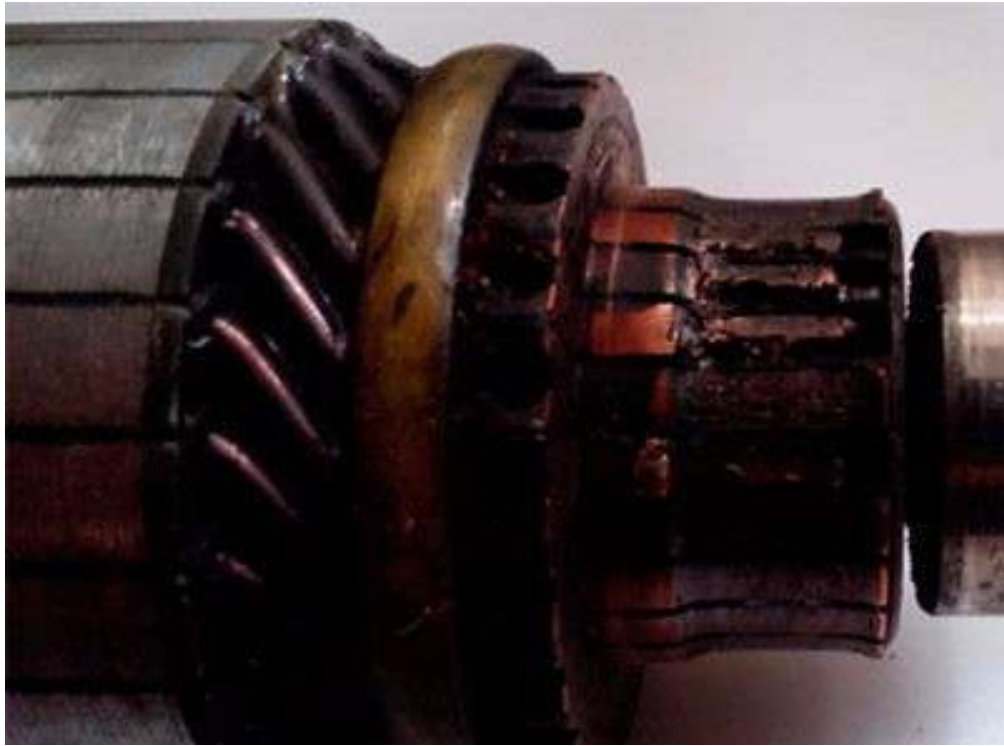
Рисунок 1.11 - Результат зносу струмознімального колектора
