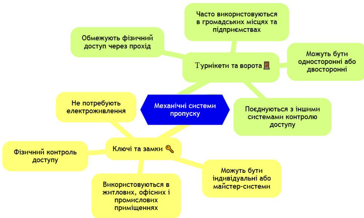
Рисунок 1.1 – Особливості механічних систем пропуску
