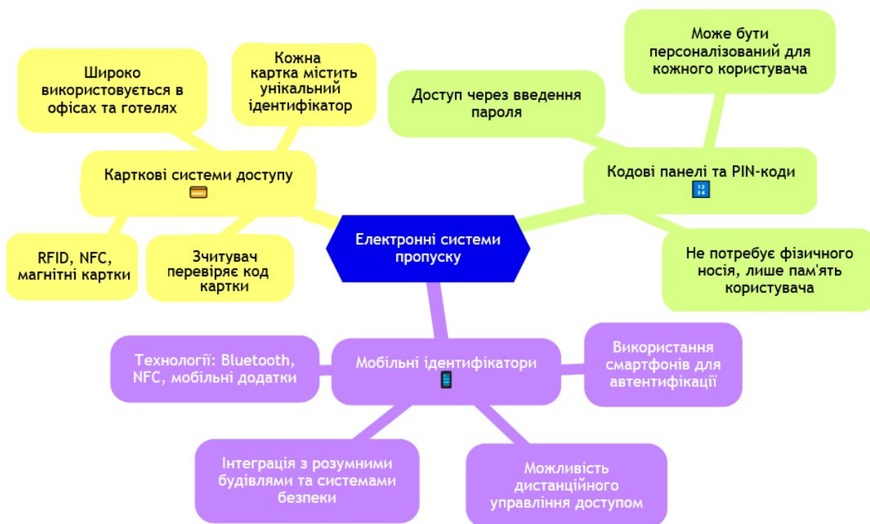
Рисунок 1.2 – Особливості електронних систем пропуску
