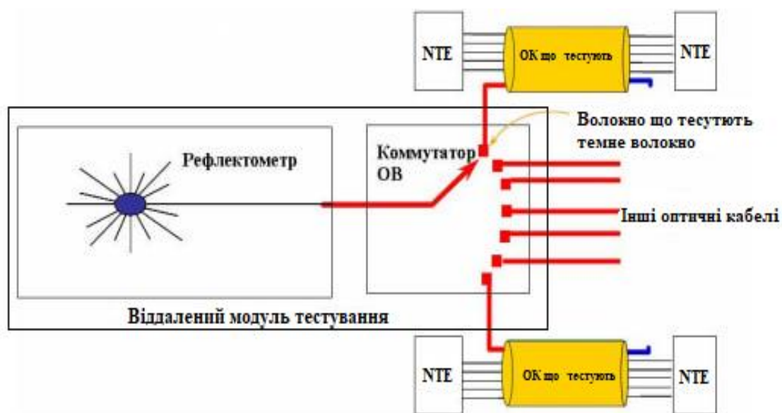
Рисунок 3.5 – Підключення пристрою віддаленого тестування RTU
