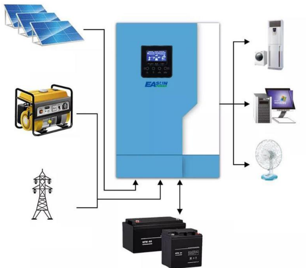
Рисунок 2.3 – Схема роботи гібридної сонячної електростанції
