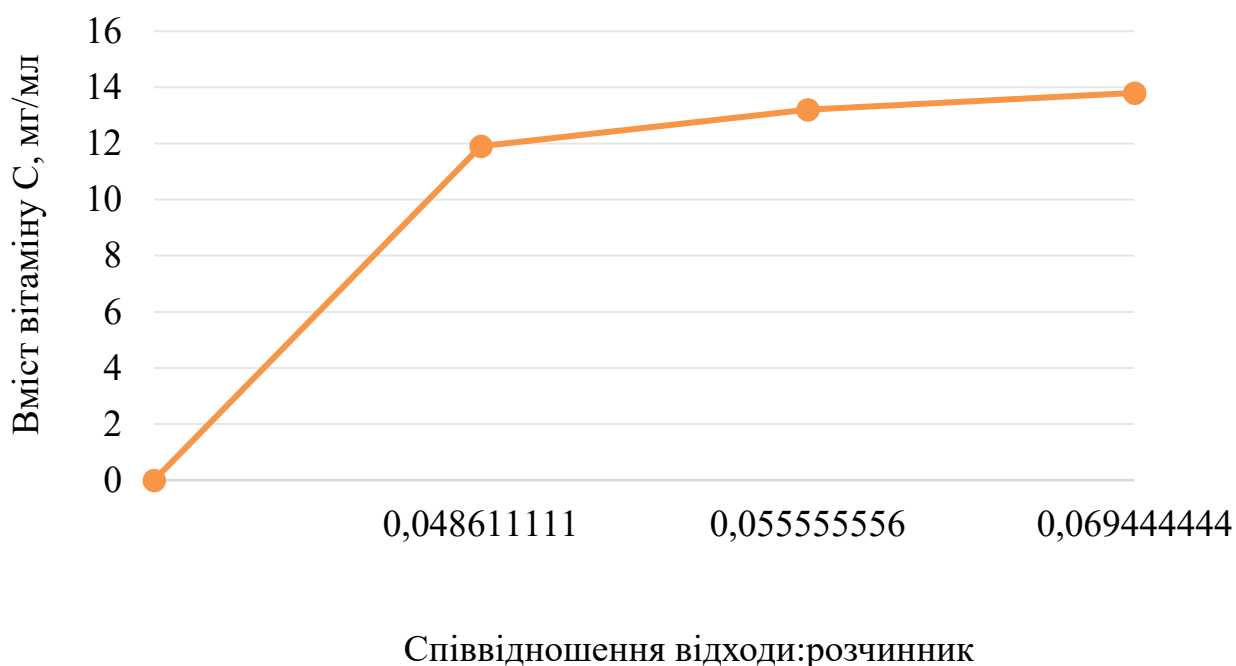
Рисунок 3.8 — Вміст вітаміну С у екстрактах добутих методом мацерації з різним співвідношенням відходи:розчинник
