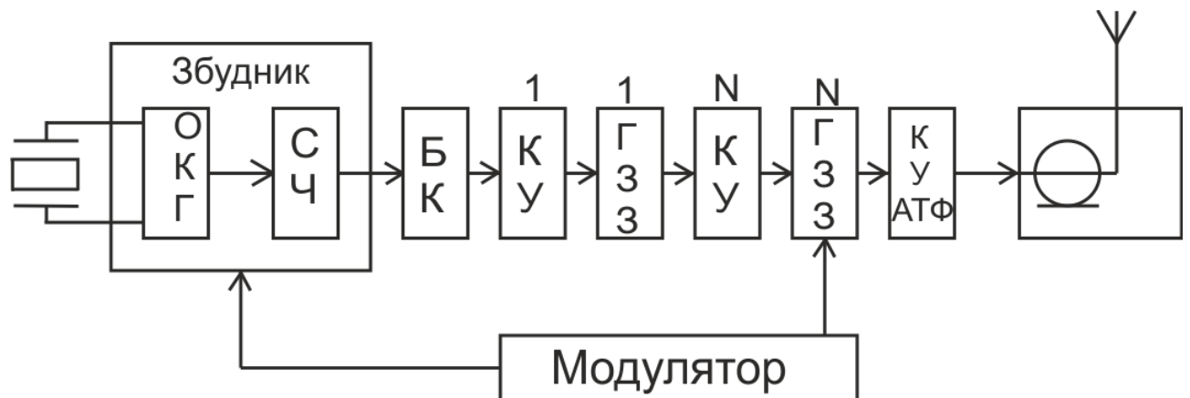
Рисунок 1 – Структурна схема радіопередавального пристрою
