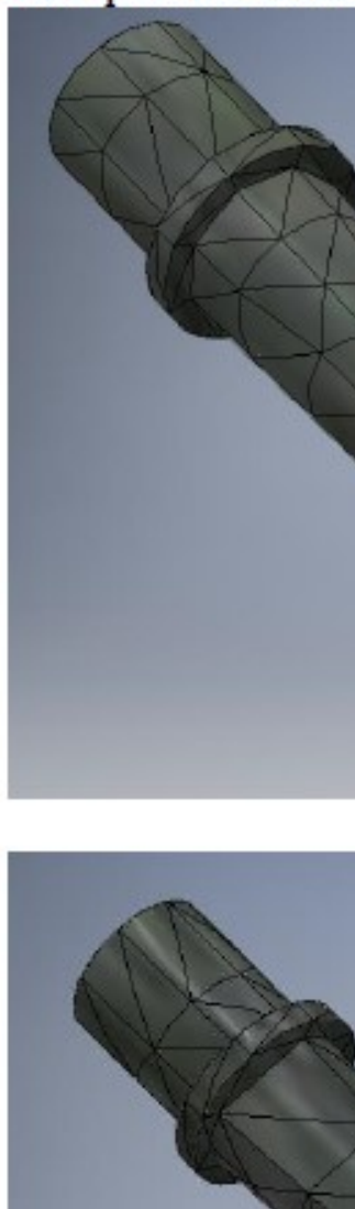
Рисунок 4.6. Розрахункові моделі розточувальних борштанг токарно-карусельного верстата: а) базова (штатна) борштанга; б) борштанга з орієнтованою жорсткістю [20]
