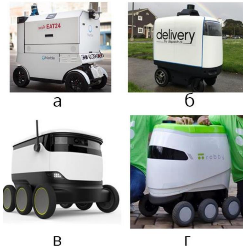
Рисунок 2.1 – Мобільні роботи для автономної доставки виробів: а – проєкт Marble [15]; б - проєкт Nuro [40]; в – проєкт Starship [16]; г - проєкт Robby [41]
