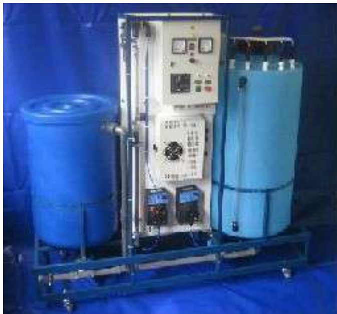
Рисунок 1.1 – Електролізер для отримання водню
