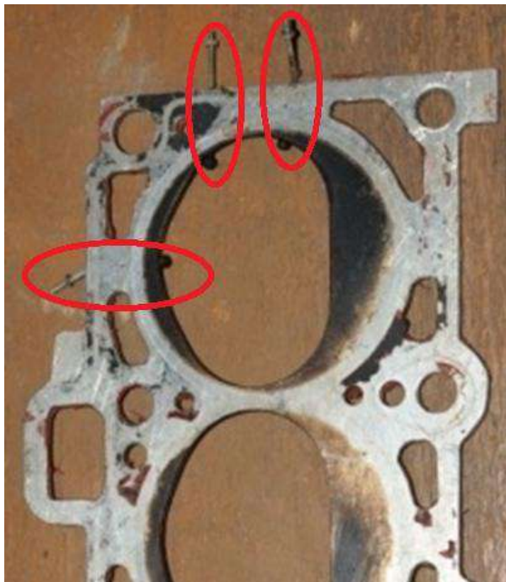
Рисунок 2.7 – Загальний вигляд датчиків на дослідження електропровідності полум'я, в двигуні ВАЗ-2111: алюмінієві датчики у спеціальній пластини.
