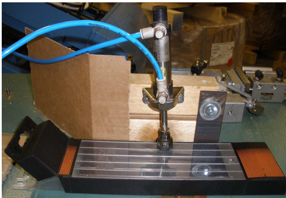
Рисунок 4.6 – Альтернативний варіант відкриття пустої коробки: а – принципова схема; б – зовнішній вигляд (1 – вакуумна насадка; 2 – циліндр )
