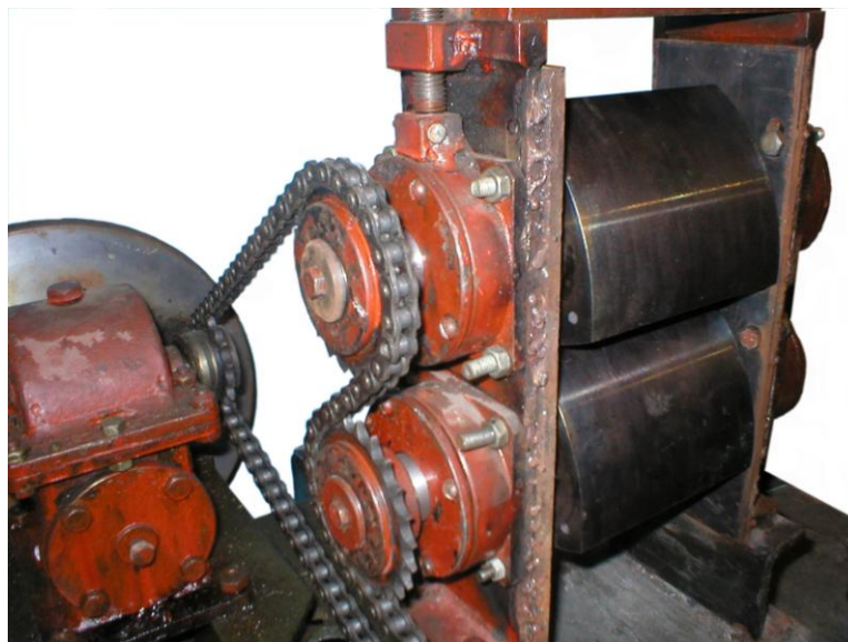
Рис. Н.1. Пристрій із валками профілю Рело
