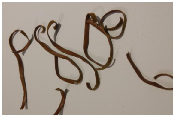
Рис. Р.2. Утворення вільної поверхні полімерного зразка: а – штучна шкіра з поліпропілену; б – поліетиленова плівка
