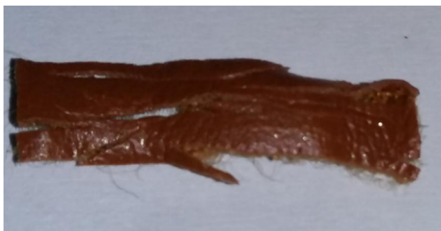
Рис. Н.3. Утворення вільної поверхні полімерного зразка: а – штучна шкіра з поліпропілену; б – підшва з ПВХ
