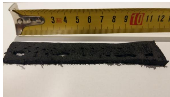
Рис. Н.3. Утворення вільної поверхні полімерного зразка: а – штучна шкіра з поліпропілену; б – підшва з ПВХ
