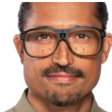
Рисунок 1.2 – Приклад використання окулярів для відстеження положення очей [5]
