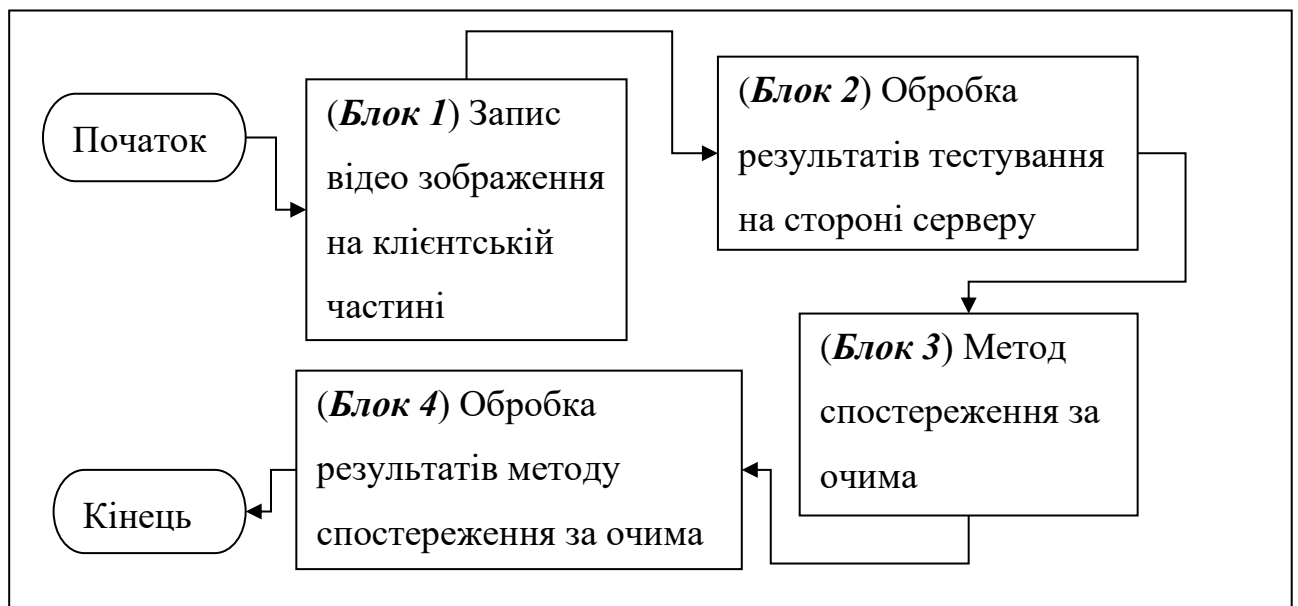
Рисунок 2.1 – Загальна схема методу спостереження за поглядом очей у відео потоці
