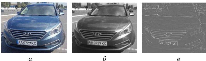
Рис. 5. Захоплене зображення та процедура обробки: а) оригінальне зображення з явно вираженою пікселізацією; б) просторова фільтрація Гауса; в) виділення країв за допомогою детектора Кенні
