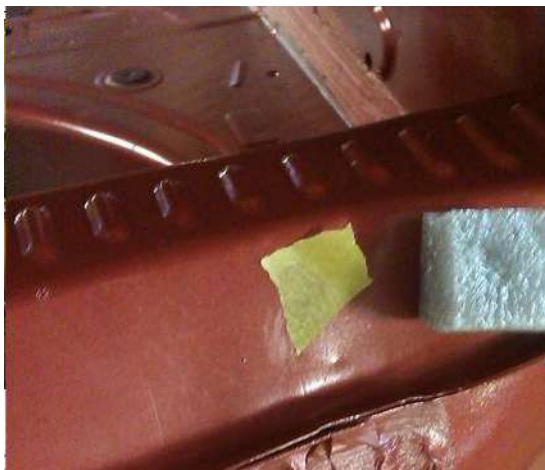
Рисунок 21 - Вм'ятину обшивки задній панелі
