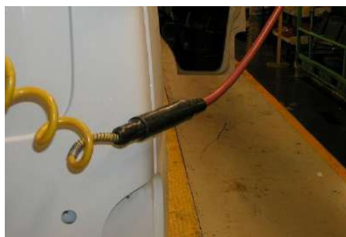
Рисунок 19 а - Металевий штуцер не ізолюваний дряпає панель
