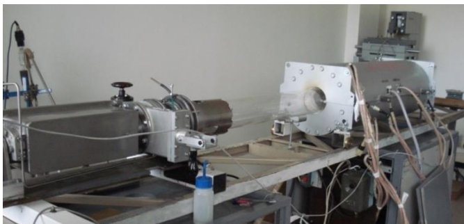
Рис. 2.5 – Установка рідиннофазної епітаксії, яку використовували для формування градієнтних епітаксійних шарів твердого розчину AlGaAs.
