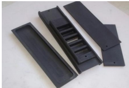
Рис. 2.8 – Графітова поршнева касета для кристалізації варізонних шарів з градієнтним розподілом легуючих домішок методом рідиннофазної епітаксії шляхом введення холодного тіла в робочу зону реактора.
