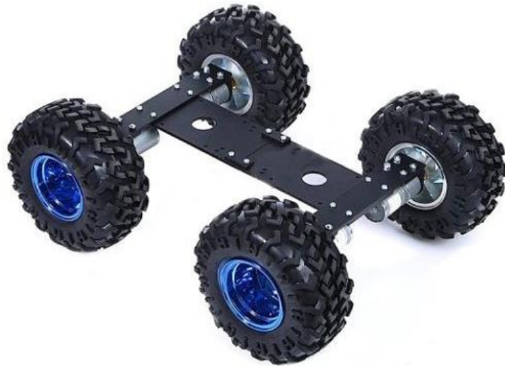
Рисунок 1.15 – Виконання чотириколісного робота із чотирма фіксованими активними колесами
