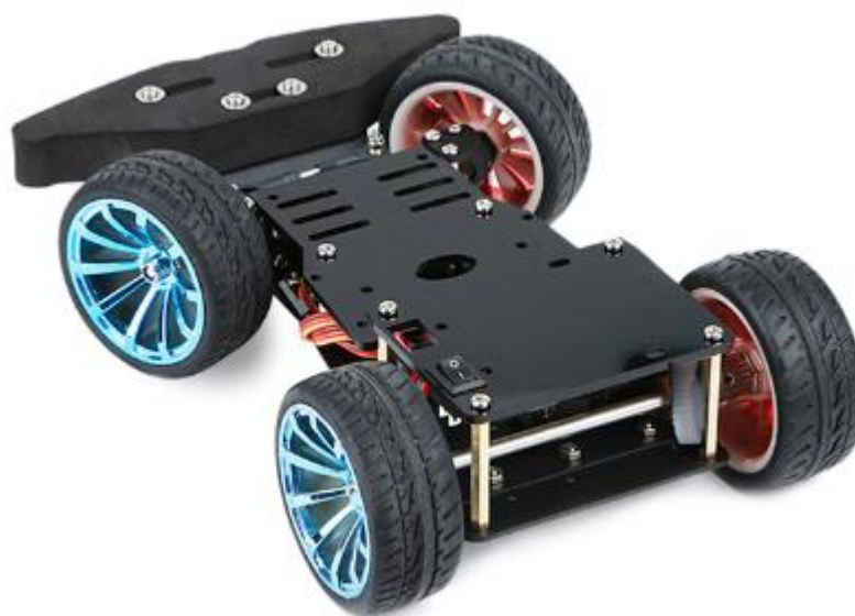
Рисунок 1.19 – Робот з активними двома приводними і активними двома поворотними колесами
