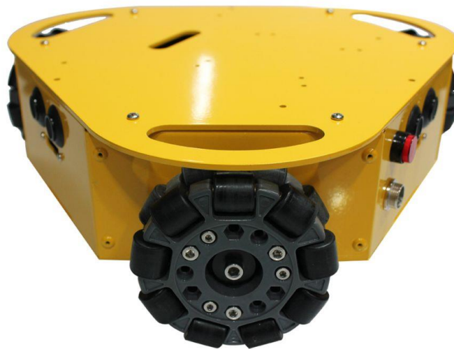
Рисунок 1.10 – Робота із шведським фіксованим колесам
