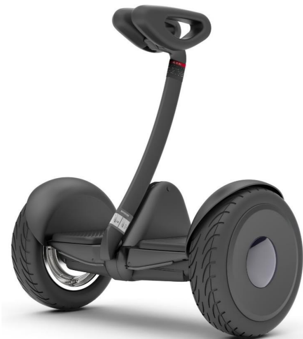
Рисунок 1.5 – Самобалансуючий двоколісний робот
