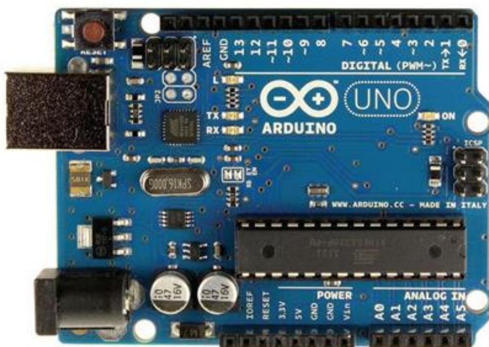
Рисунок 2.4 – Мікроконтролер Arduino Uno
