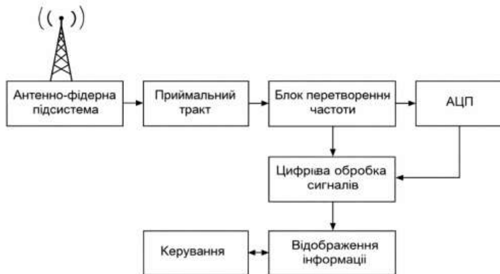
Рисунок 1.1 – Узагальнена структурна схема системи радіотехнічного моніторингу
