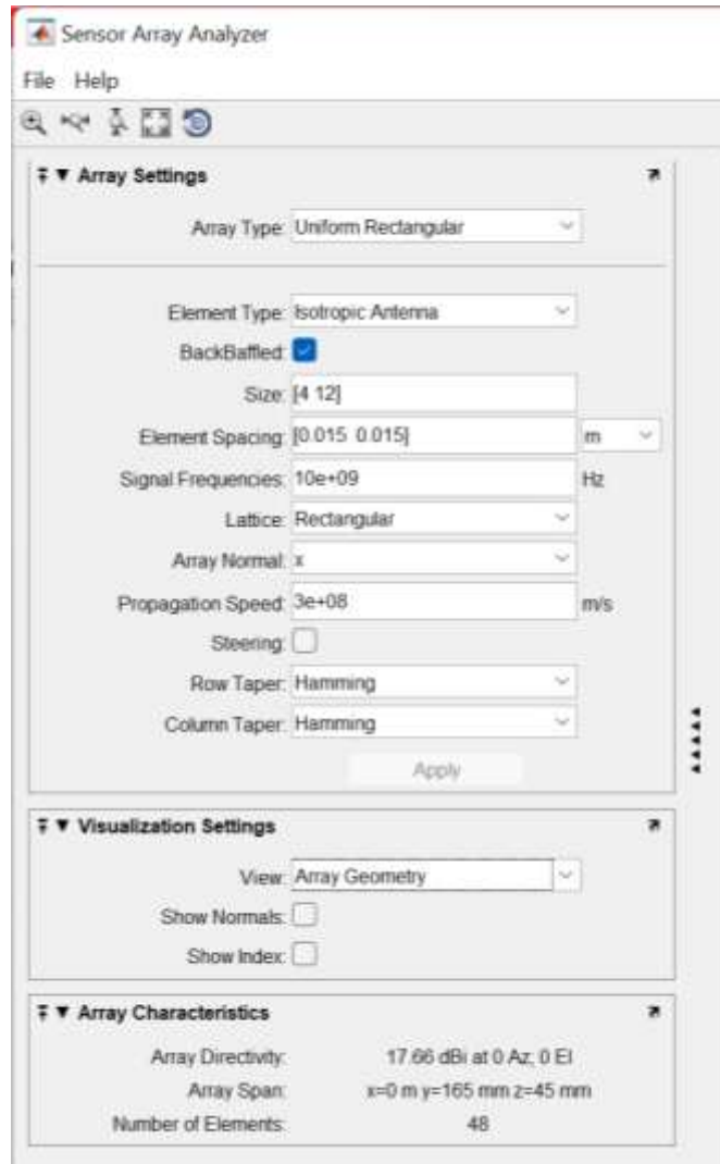
Рисунок 2.5 – Результати розрахунку параметрів антенної підсистеми в середовищі аналізу решіток (Sensor Array Analyzer)
