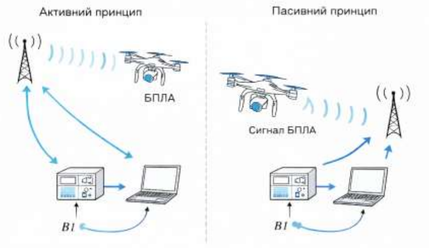
Рисунок 1.5 – Активний та пасивний принципи радіотехнічного моніторингу
