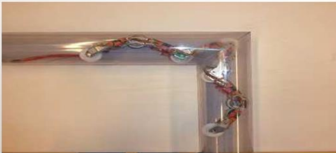
Тестування прохідності робота в трубі діаметром 86 мм при наявності вигину труби: а – симуляція; б – експеримент
