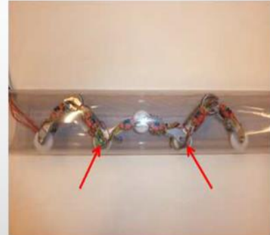
Тестування прохідності робота в трубі діаметром 116 мм: а – симуляція; б – експеримент
