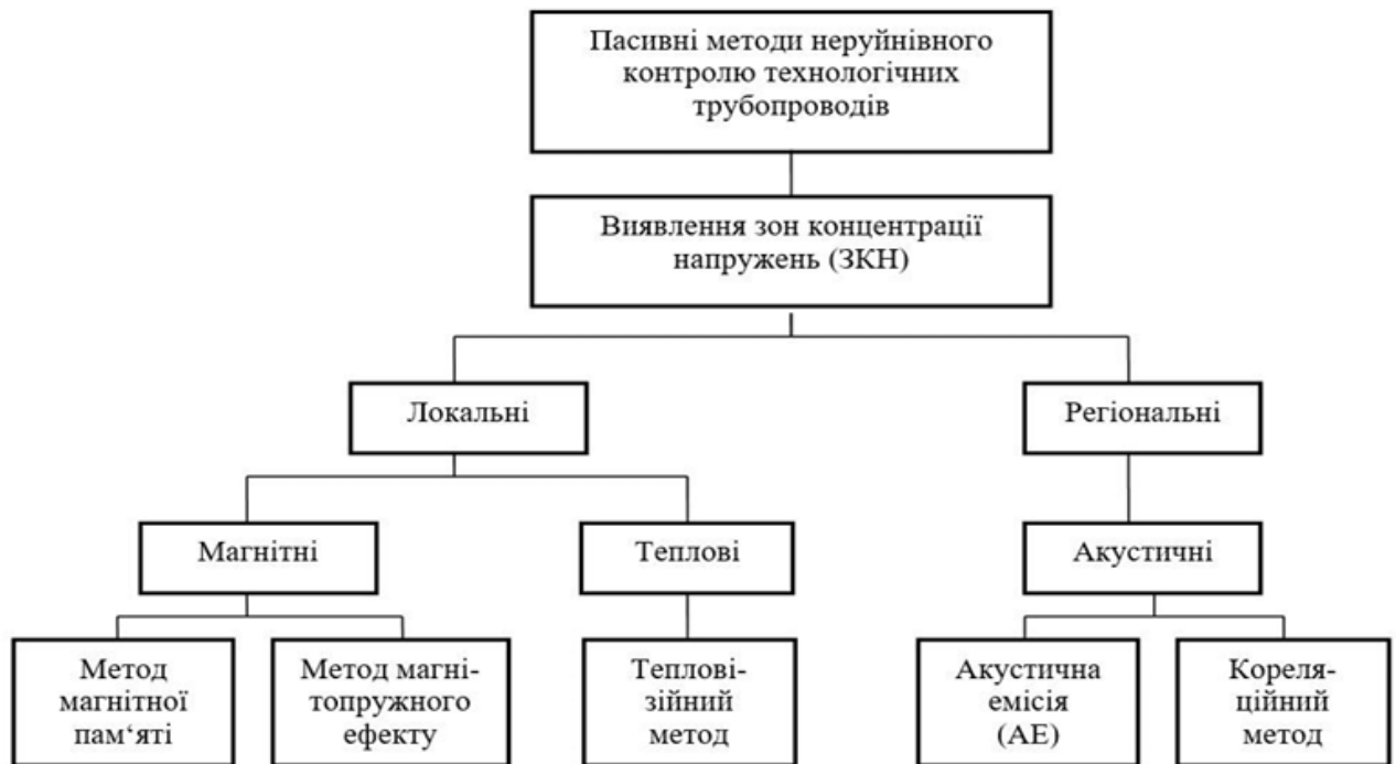
Рисунок 1.5 – Класифікація пасивних методів НК
