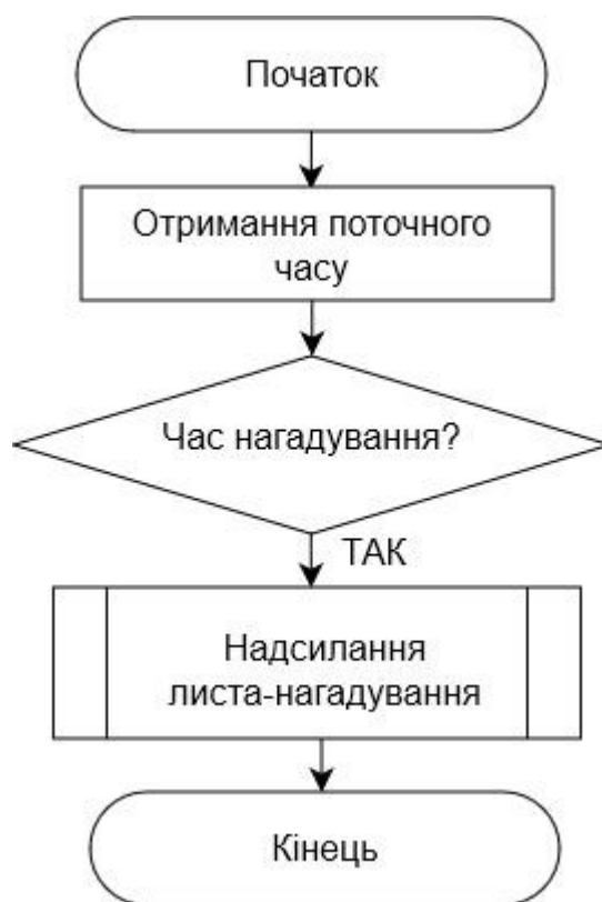
Рисунок 3.9 – Блок-схема алгоритму нагадування про рівень води в резервуарі у формі надсилання листа на електронну пошту
