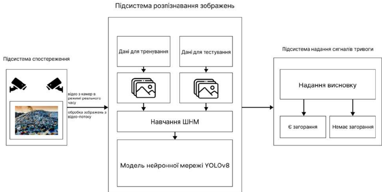
Рисунок 4.5 – Розширена структурна схема системи раннього виявлення пожеж на сміттєзвалищах
