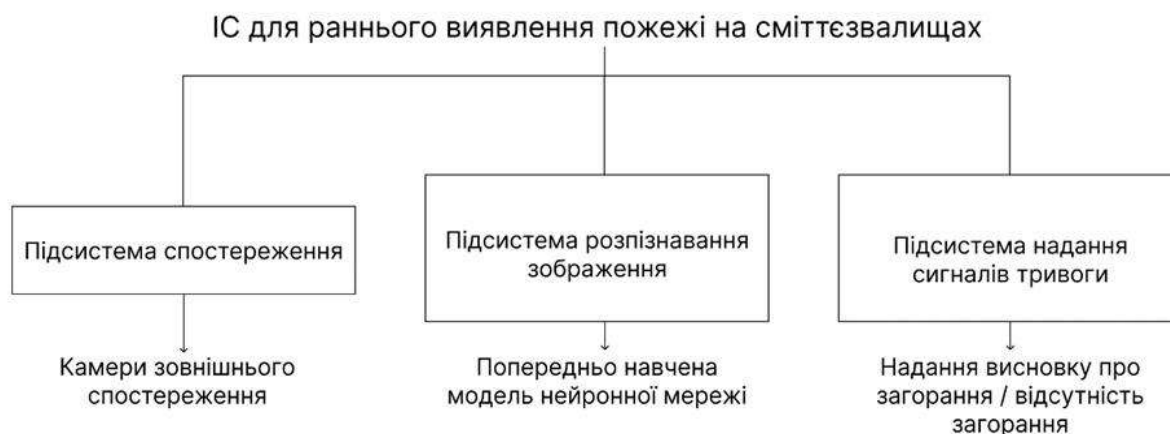
Рисунок 4.4 – Діаграма декомпозиції системи раннього виявлення пожеж на сміттєзвалищах
