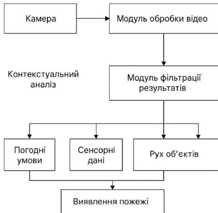
Рисунок 4.7 – Алгоритм функціонування системи виявлення пожеж на сміттєзвалищах на основі комп'ютерного зору та прогнозування погодних умов
