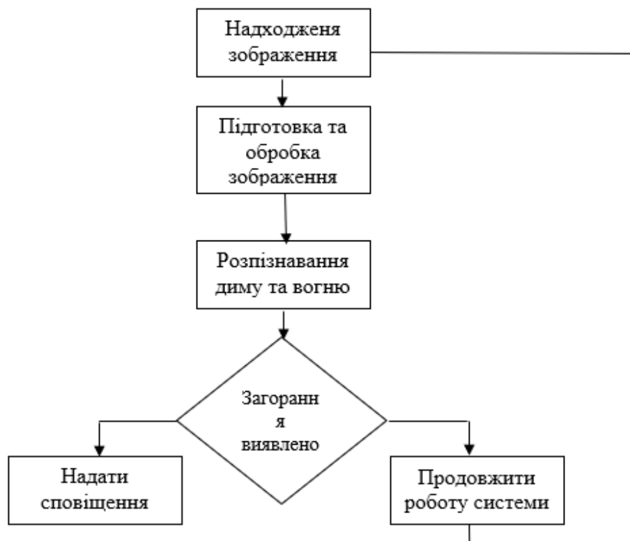
Рисунок 4.3 – Ієрархічна структура програмної системи виявлення пожеж на сміттєзвалищах (послідовність виконання дій в системі)
