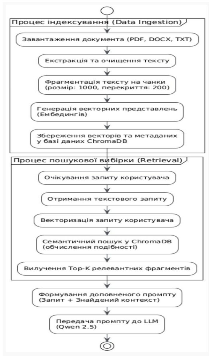
Рисунок 2.3 – Блок-схема алгоритму обробки документів та пошукової генерації (RAG)
