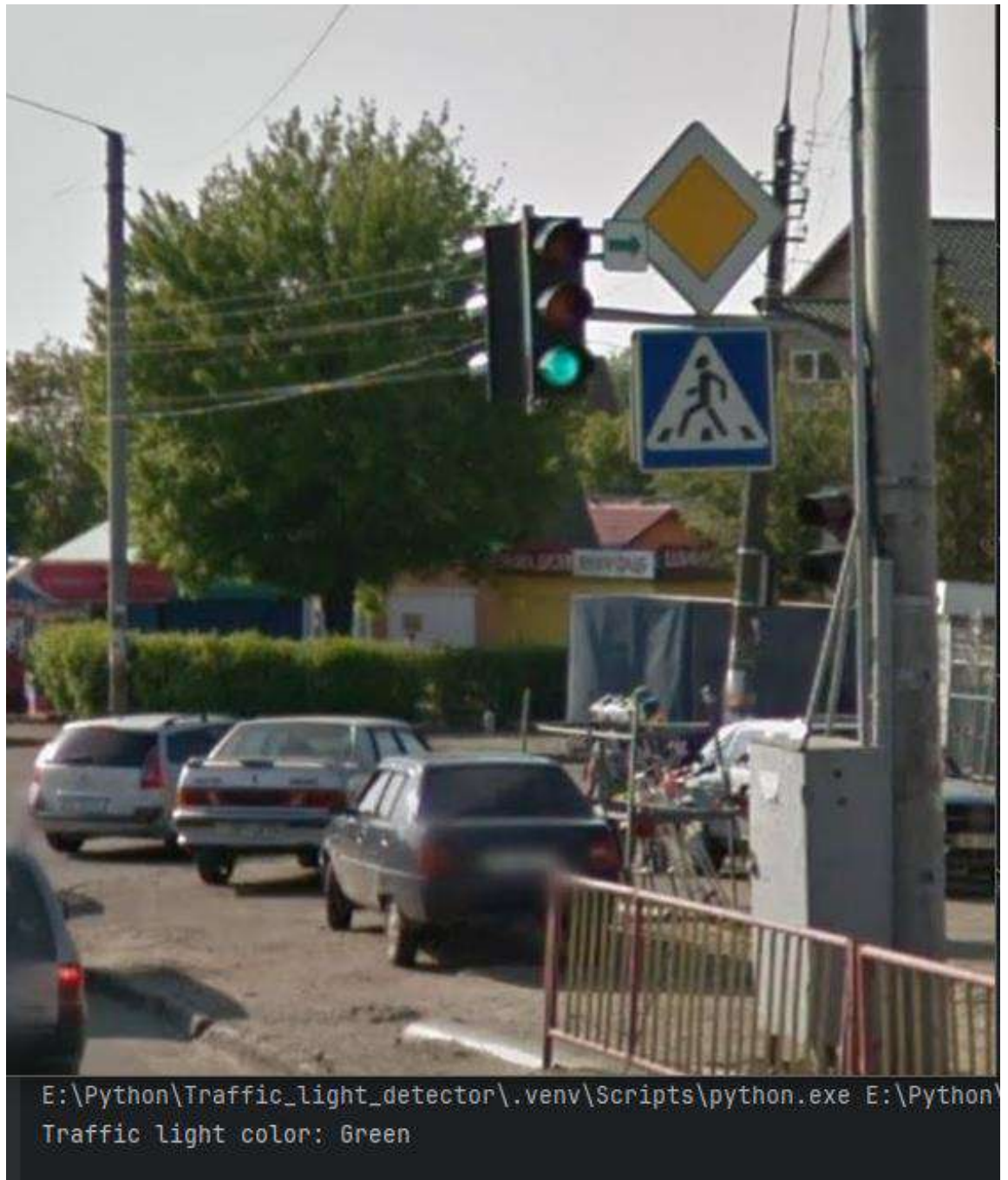
Рисунок 3.3 – Розпізнавання світлофора за допомогою методу сегментації
