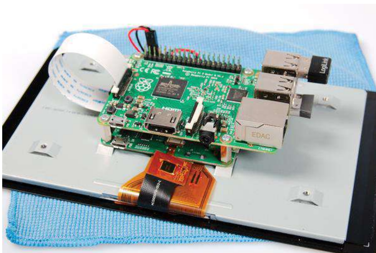
Рисунок 3.2 – 7” дисплей, до якого примонтований міні-комп'ютер [74]
