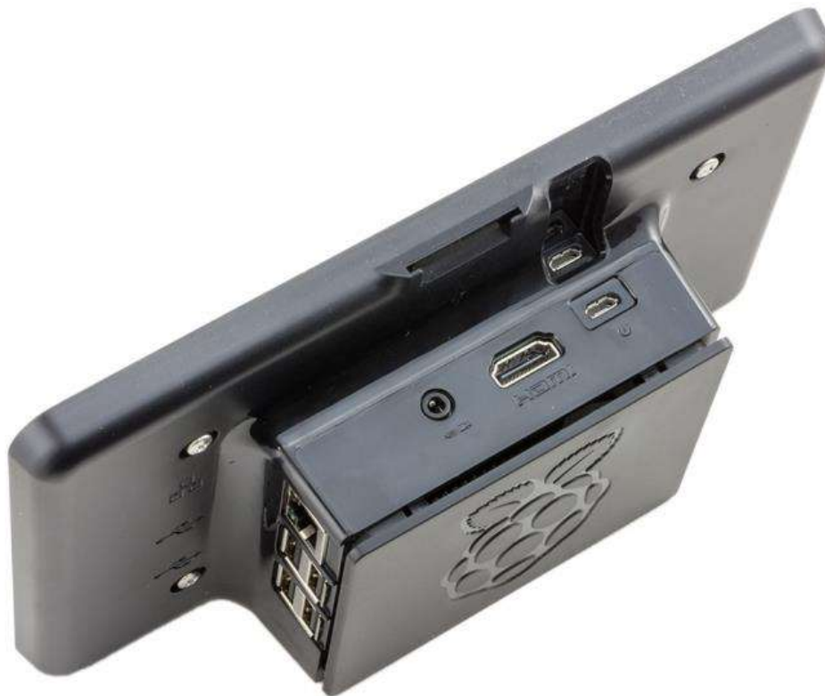
Рисунок 2.4 – Дисплей для Raspberry PI 3 B+ та сам мікрокомп'ютер в корпусі (вигляд ззаду) [39]
