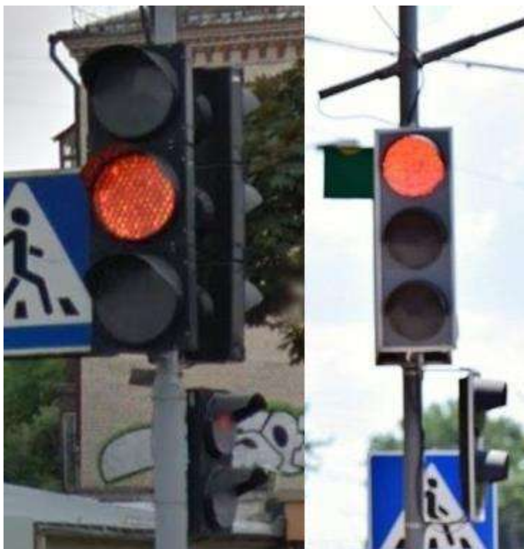
Рисунок 4.2 – Світлофори з різними сигналами, але однаковими кольорами
