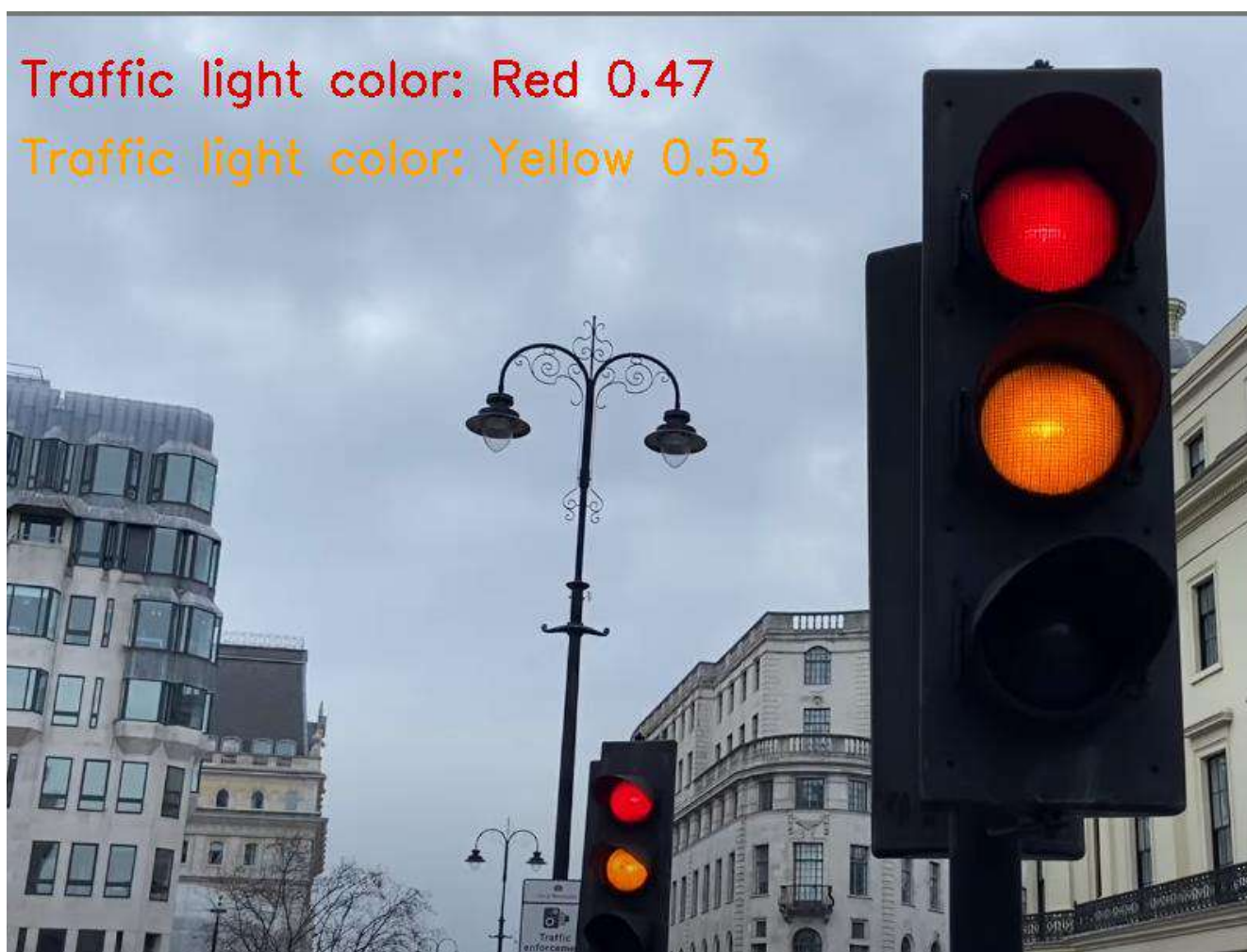
Рисунок 4.7 – Розпізнавання червоного та жовтого сигналу світлофора
