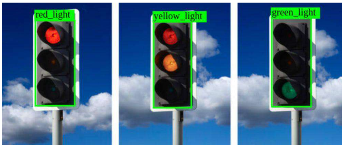
Рисунок 2.5 – Розпізнавання кольорів світлофора моделлю YOLOv4 [44]
