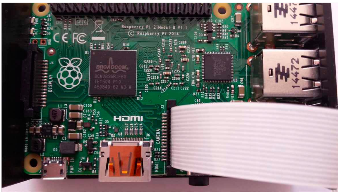
Рисунок 3.12 – Зображення конектора камери підключеного до роз'єма плати Raspberry Pi
