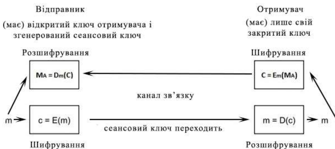
Рисунок 2.2 – Алгоритм роботи RSA
