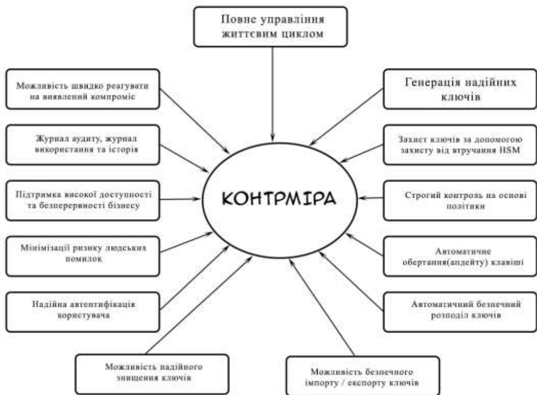
Рисунок 4.3 – Контролі для захисту ключів алгоритму апаратного модулю HSM
