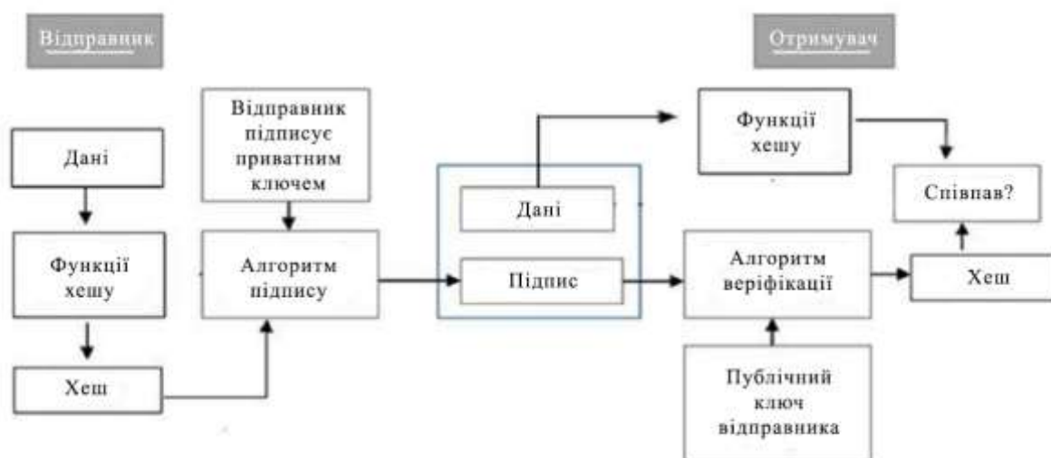
Рисунок 2.3 – Блок-схема цифрового підпису
