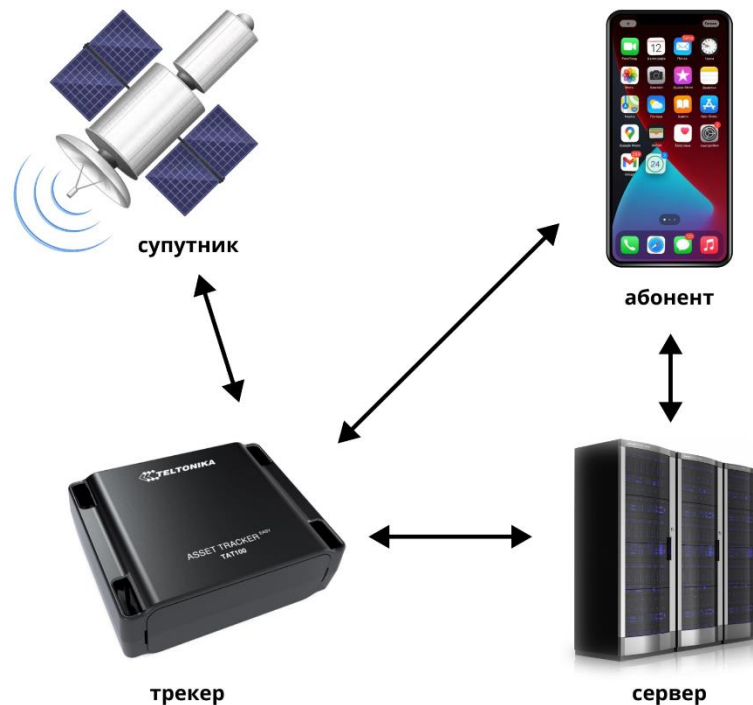
Рисунок 2.4 - Принцип роботи персонального GPS-трекера
