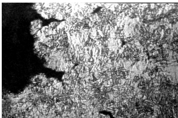
Рис. 6. Микроструктура осаждённой меди (продольный разрез), × 120
