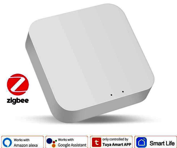
Рисунок 2.13 – Міні Zigbee мережний міст / шлюз / концентратор / пульт дистанційного керування для “розумного будинку”
