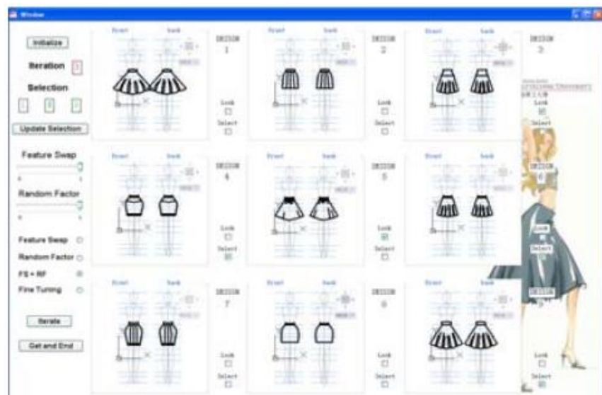
Рис. 1.4. Побудова технічного ескізу спідниці жіночої методом комбінаторного синтезу
