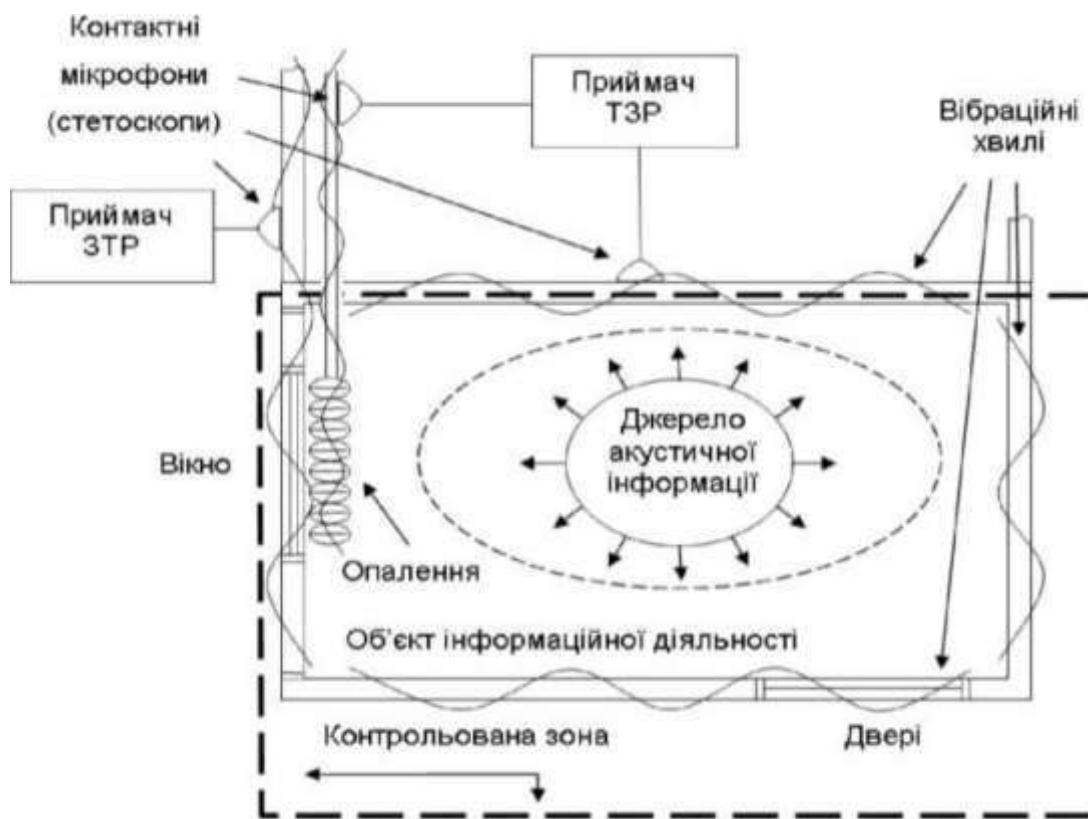
Рисунок 1.4 – Схема утворення віброакустичного каналу витоку акустичної інформації в приміщенні
