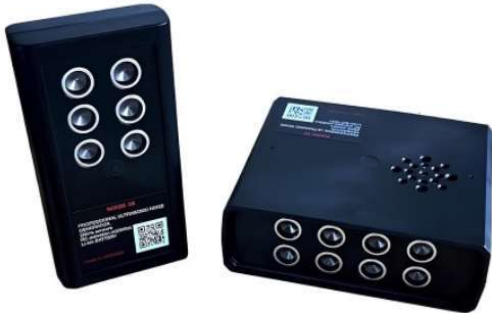
Рисунок 1.7 – Пригнічувач диктофонів Flux NOISE 3S
