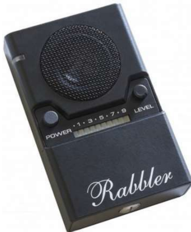
Рисунок 1.6 – Мобільний шумовий генератор акустичного шуму
