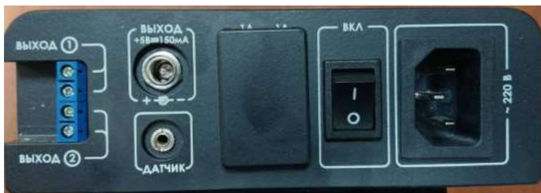
Рисунок 3.2 – Вихідні канали генератора МАРС-ТЗО-4-2
