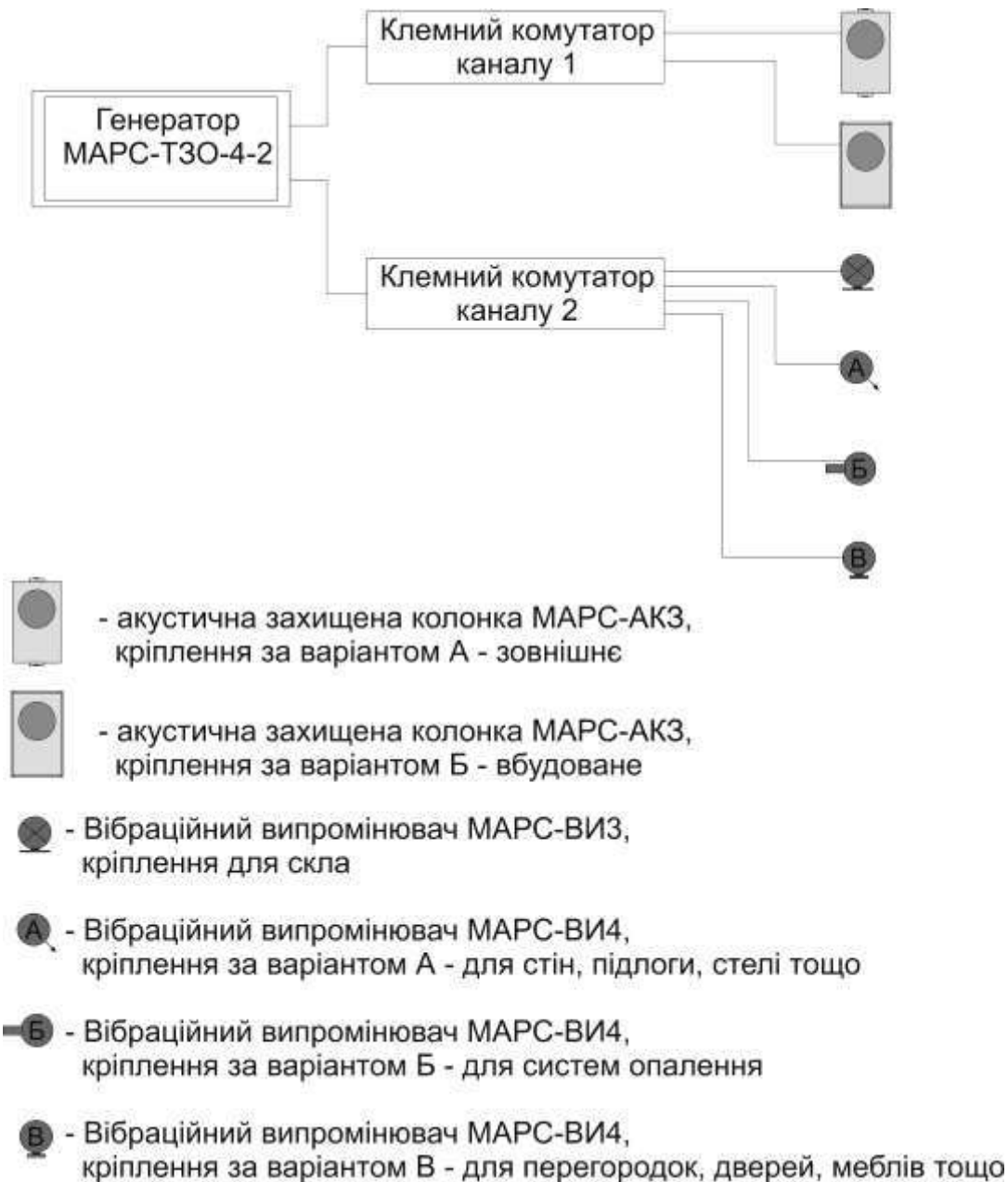
Рисунок 3.10 – Схема системи для дослідження технологій і засобів захисту інформації від витоку віброакустичними каналами
