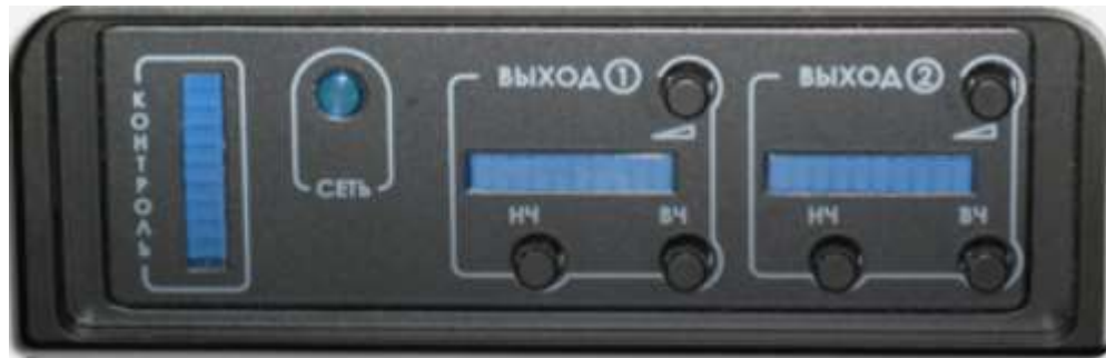
Рисунок 3.3 – Панель індикації генератора МАРС-ТЗО-4-2
