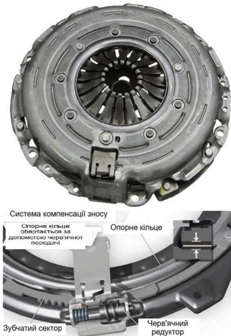
Рисунок 1.5 – Особливості конструкції саморегульовного зчеплення SAT
