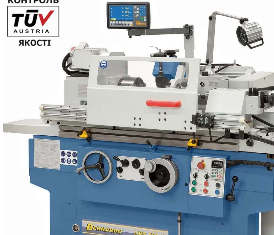
Рисунок 1.13 – Круглошліфувальний верстат серії Bernardo URS 500 N
