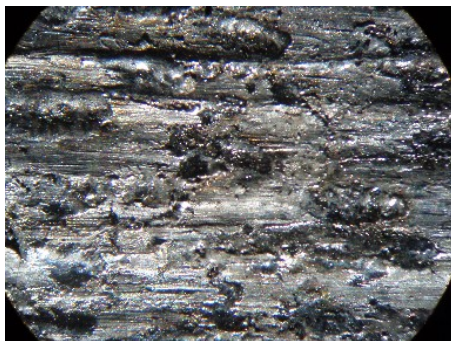
Рисунок 4.1 – Поверхня газотермічного захисного покриття після чорнової обробки МЕШ ( \times 60 )
