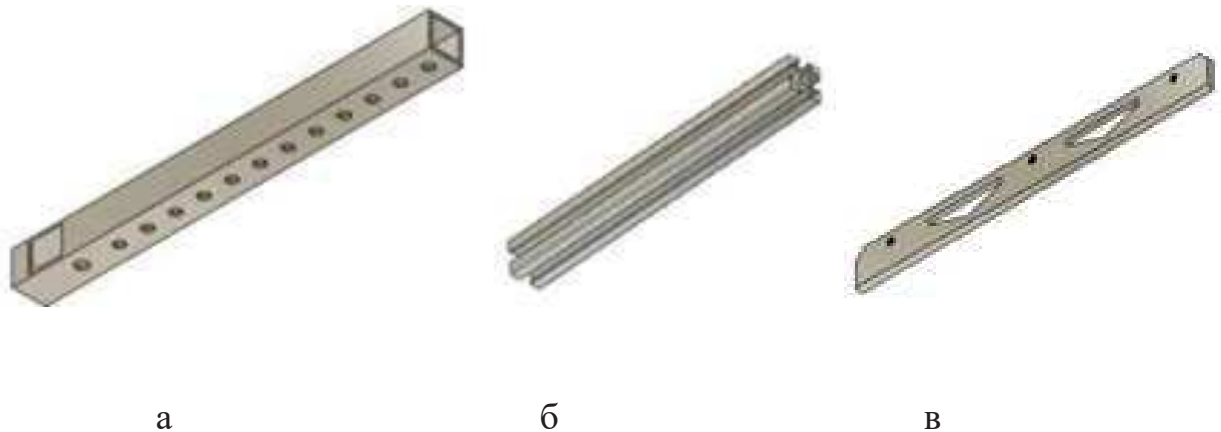
Рисунок 2.11 - Елементи кріплення та направляючі для двигуна, маніпулятора та ножа показані на: а - направляючі для двигуна; б - маніпулятора; в - ножа
