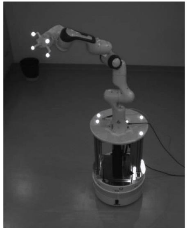
Рисунок 3.1 – Робот МоСар з маркерним інструментом (ліворуч), ПЧ-зображення, зняте камерою МоСар (праворуч) [58]
