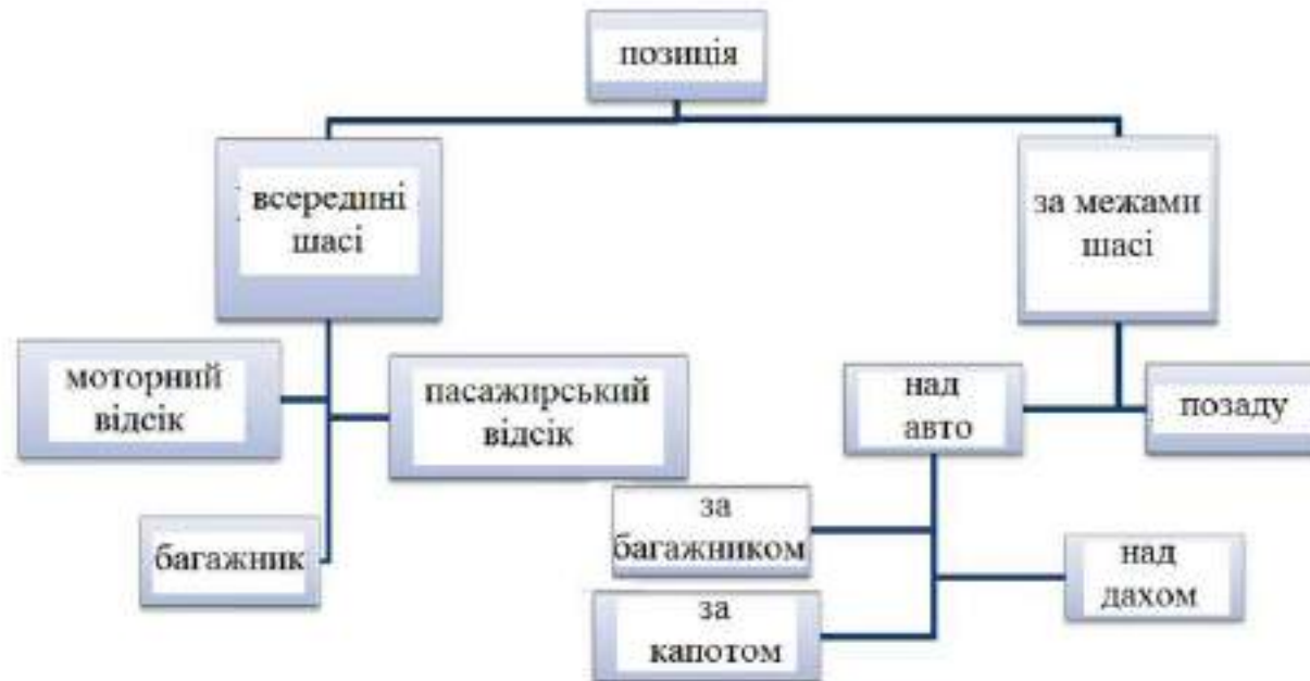
Можливі позиції встановлення додаткового генератора.
