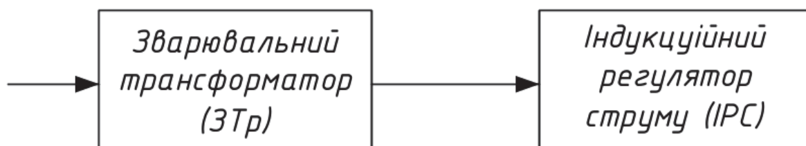
Рисунок 2.1 - Найпростіший зварювальний трансформатор
