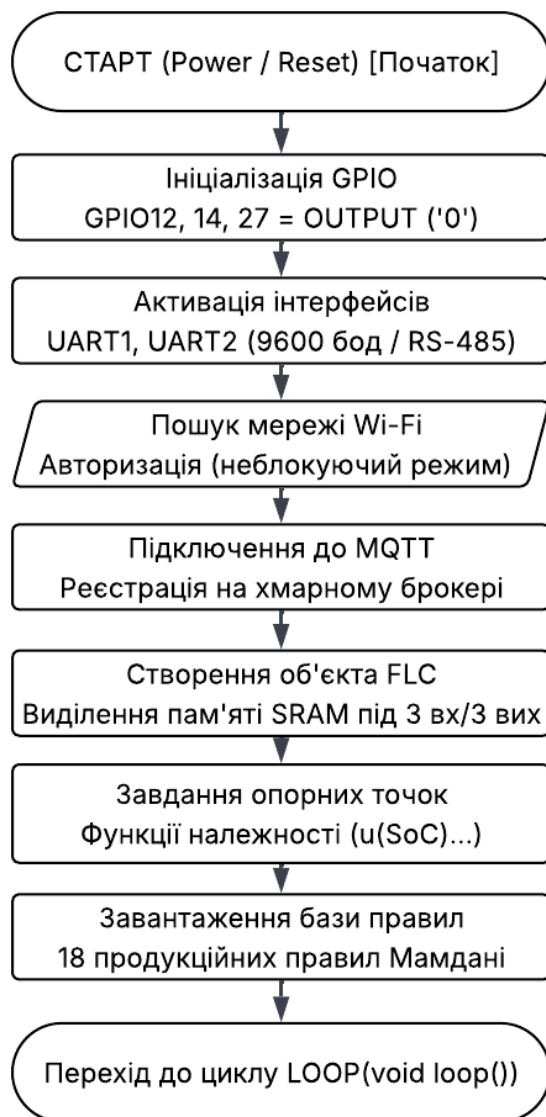
Рисунок 3.6 – Алгоритм блоку початкової ініціалізації (функція setup)
