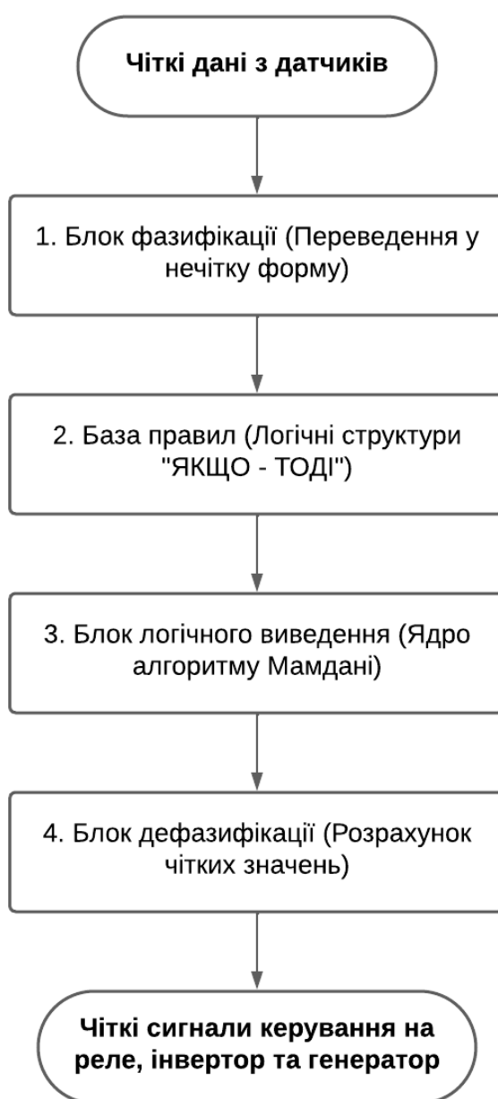
Рисунок 2.1 – Структурна схема розробленого нечіткого контролера
