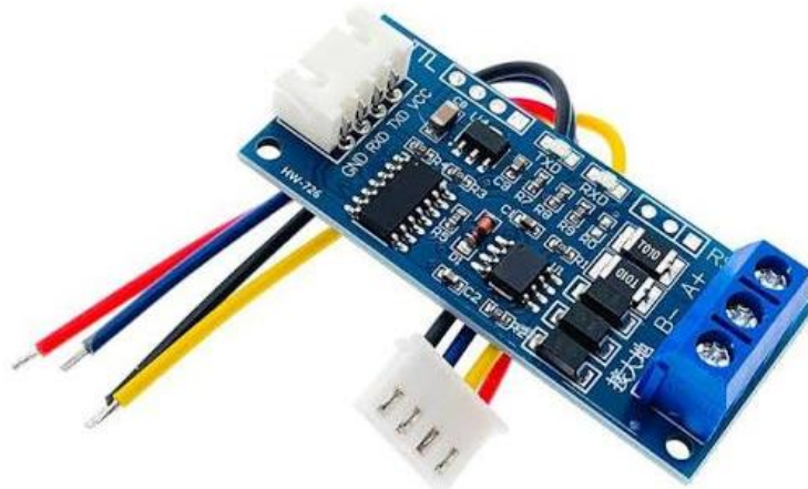
Рисунок 3.2 – Перетворювач UART в RS-485 на базі SP3485 [17]
