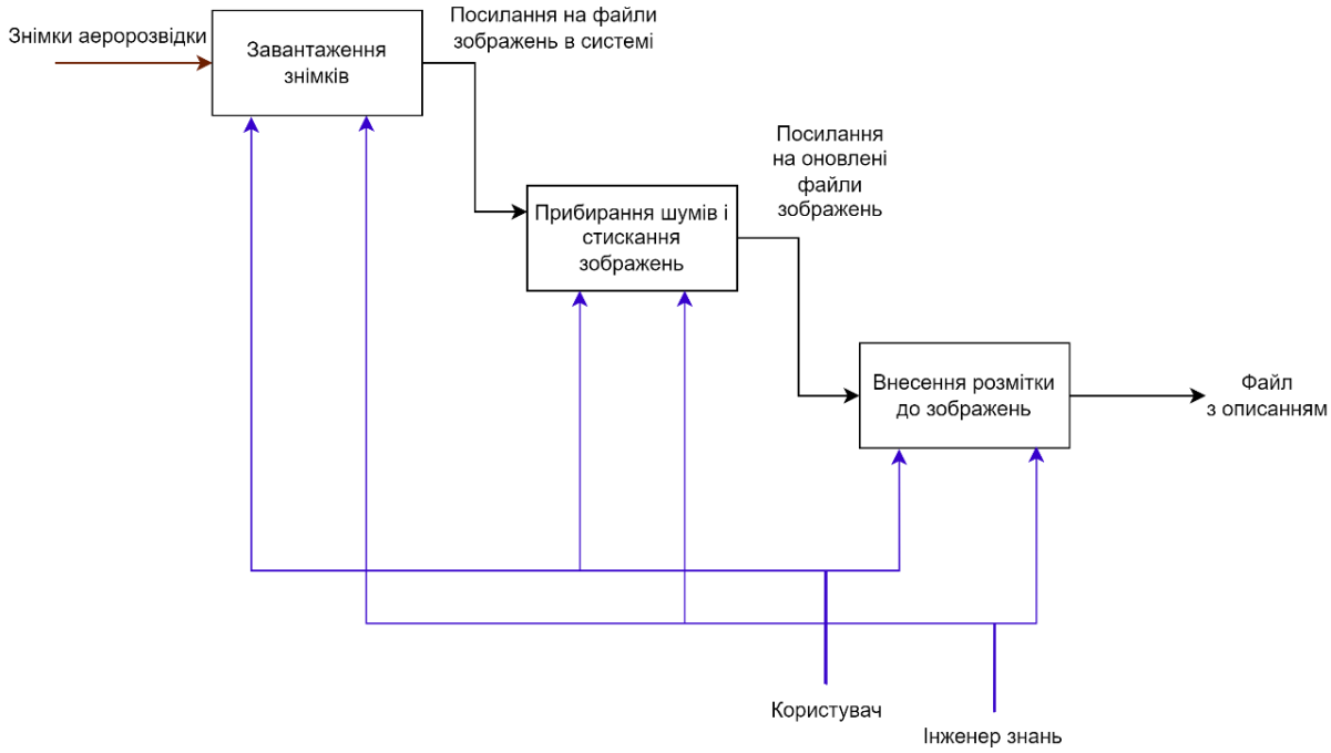
Рисунок 3.4 – Діаграма процесу попередньої обробки відеоданих
