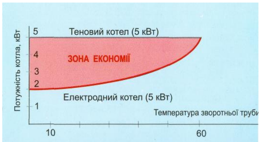
Рисунок 2.1 – Порівняння електродного і тенового принципу нагріву
