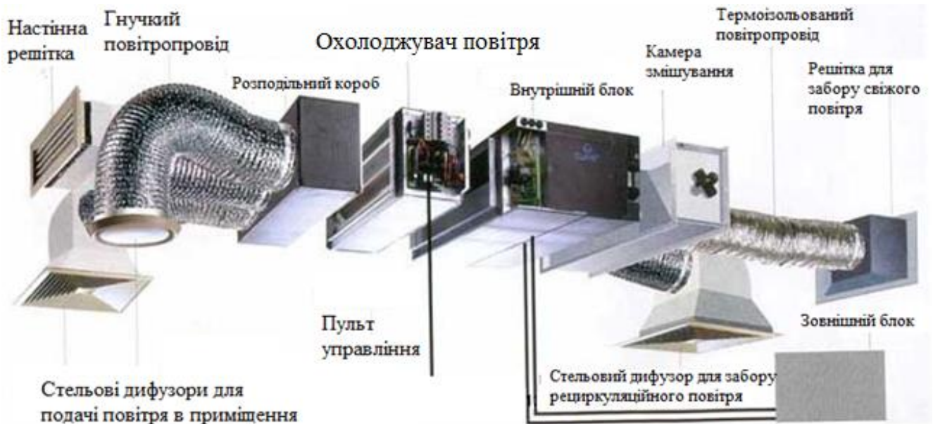
Рисунок 1.3 – Поєднання системи кондиціонування та системи вентиляції повітря
