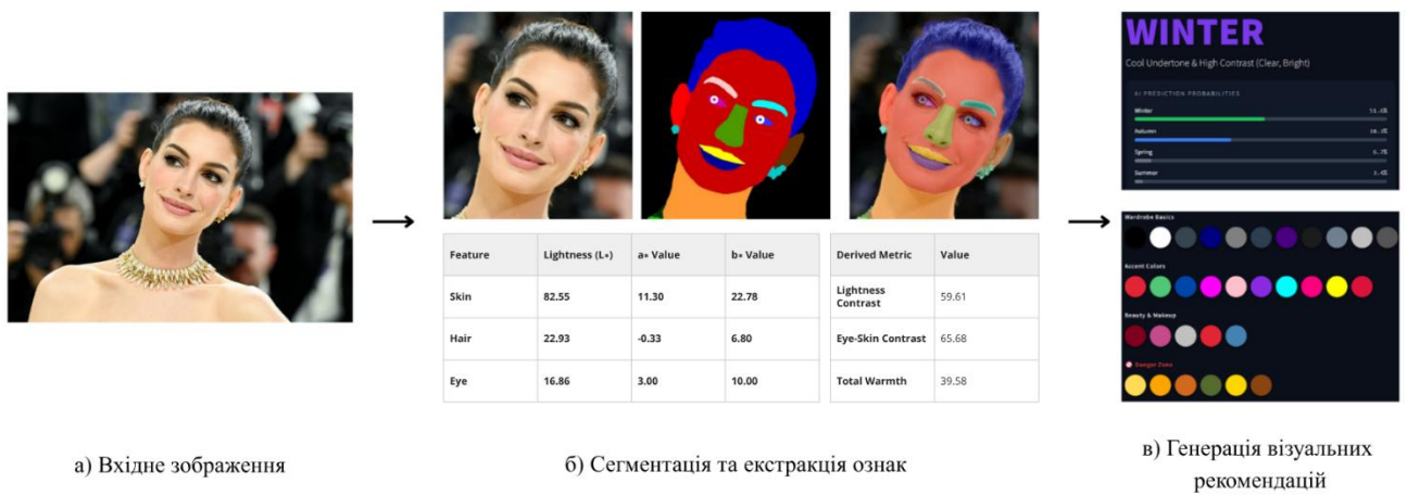
Рисунок 3.11 – Етапи обробки вхідного зображення та генерація персоналізованої колірної палітри: а) вхідне зображення; б) сегментація та екстракція ознак; в) генерація візуальних рекомендацій
