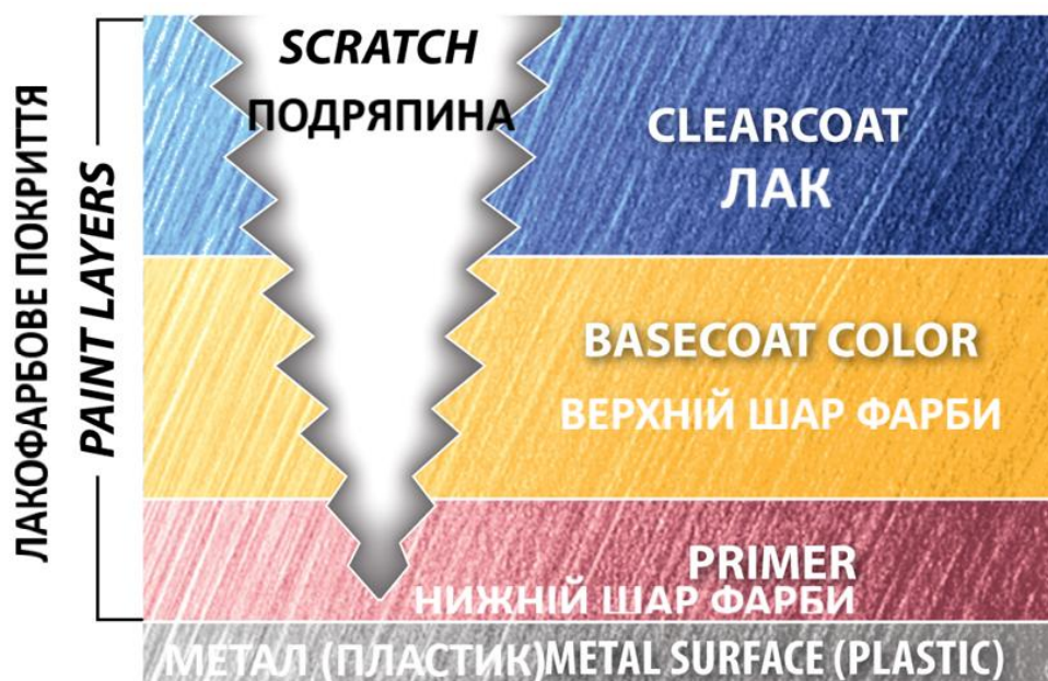
Рисунок 1.1 – Багатошарова система покриття кузова автомобіля
