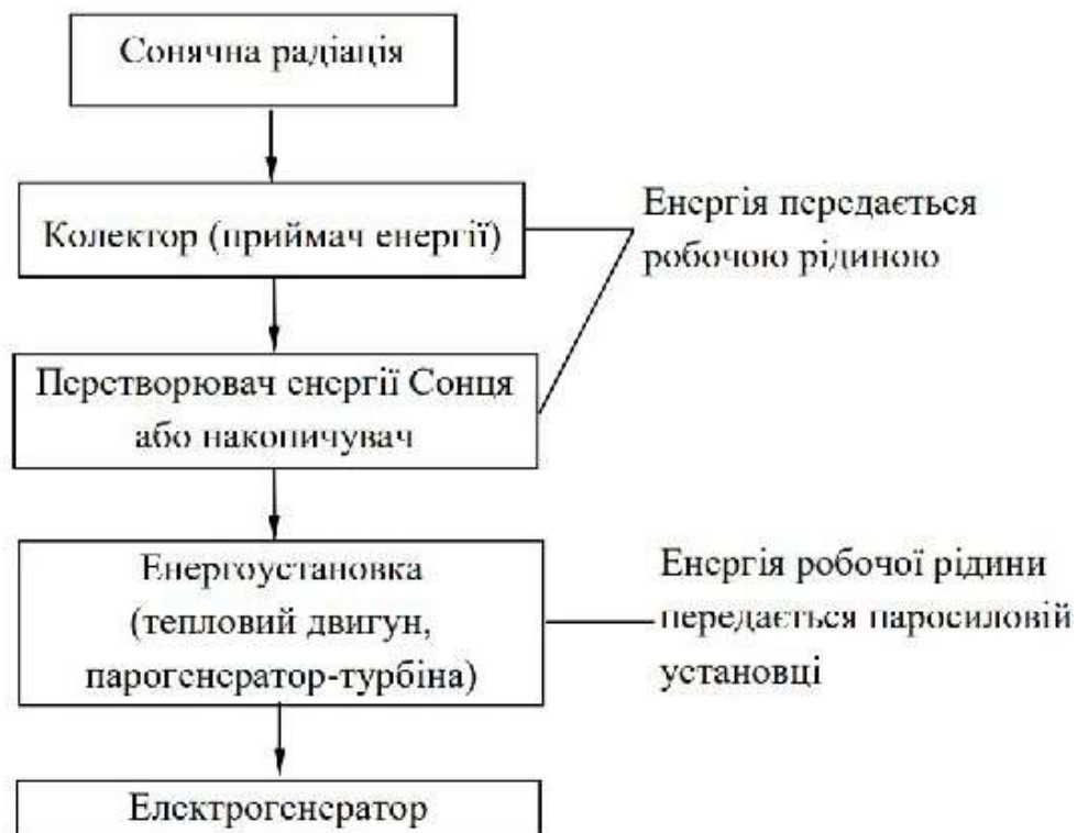
Рисунок 1.1-Принципова блок-схема сонячної теплової електростанції.
