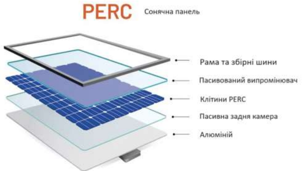
Рисунок 1.19 – Конструкція сонячної панелі PERC
