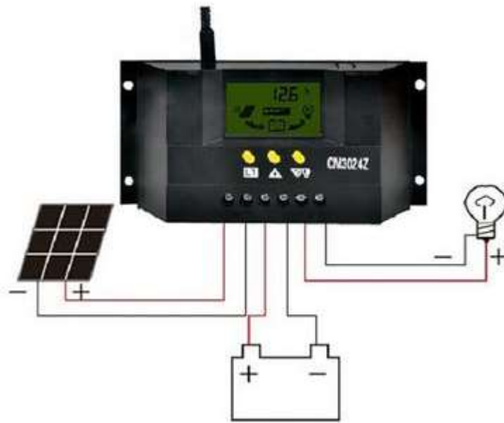
Рисунок 2.6 – Схема підключення контролера
